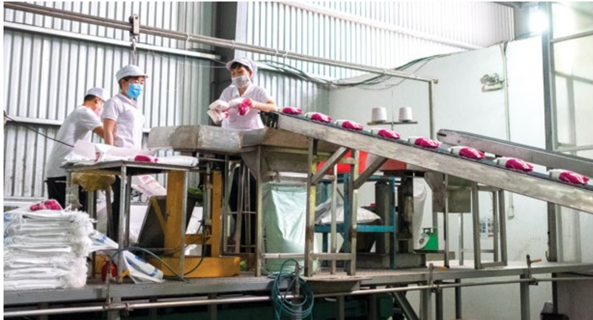
Hệ thống đóng bao tại nhà máy Biên Hòa - Đồng Nai
